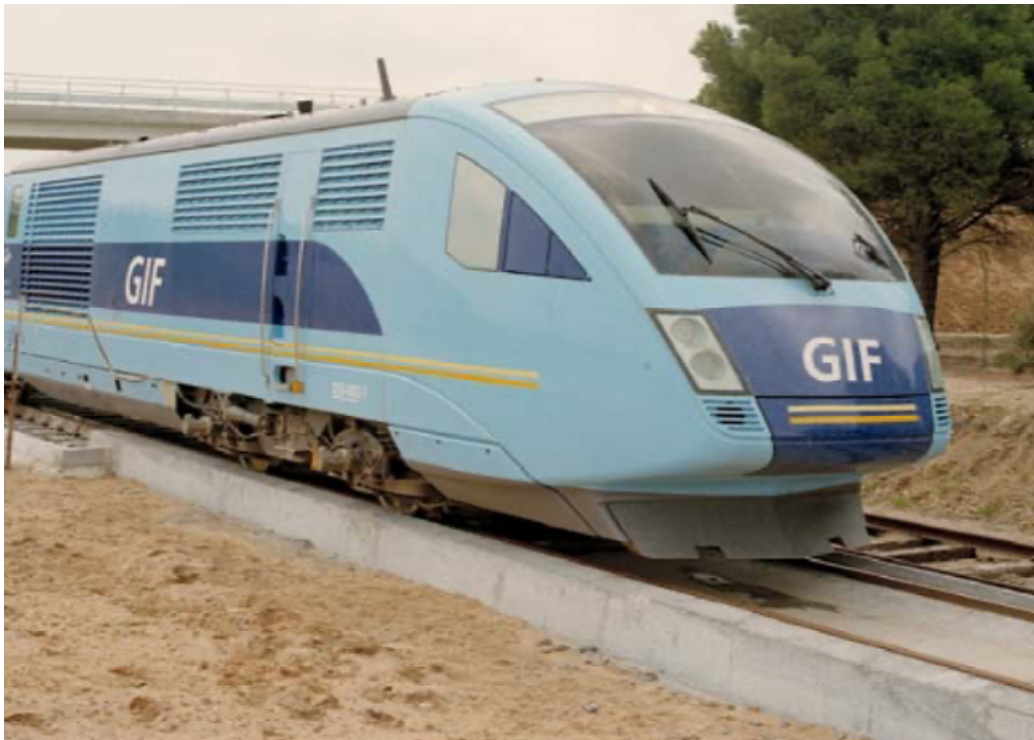
Figur 13: Ett BBEST som är i bruk i Medina, Spanien (Balfour Beatty Rail).
