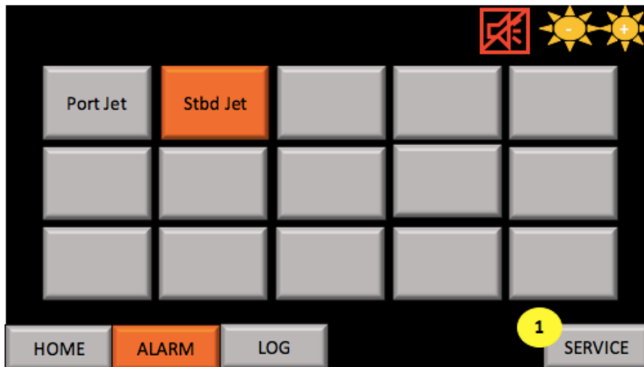
Figur 13, Larm av prioritetsordning två. Larmpanelen lyser upp orange, samt knappen för larmvyn nere till vänster börjar blinka orange. Servicevyn visar en notis på ett serviceärende.
