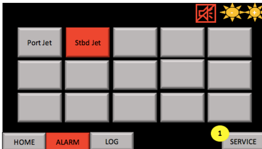
Figur 12, Larm av prioritetsordning ett. Larmpanelens knapp eller ruta lyser upp rött, samt knappen för larmvyn nere till vänster börjar blinka rött. Servicevyn visar en notis på ett serviceärende. Den röda högtalaren fungerar som möjlighet att tysta ljudsignalen.
