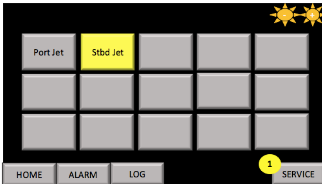
Figur 16, Larmpannelsidan efter ett bekräftat "Acknowledge" larm.
