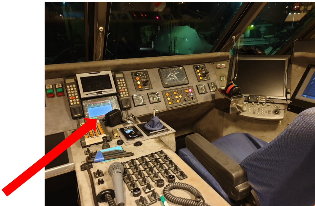
Figur 9, kommandobryggan och MJPs styrsystem ombord på Cinderella 1
