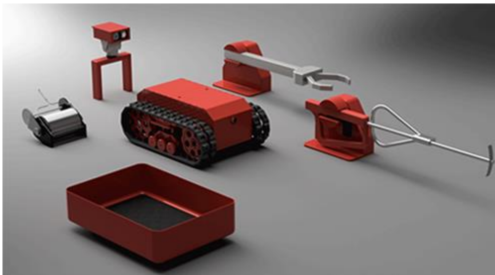
Figur 3. FUMOs grundkomponent omringad av de extrakomponenter som är tänkta att hjälpa vid brand och andra insatser (FUMO, 2016).
