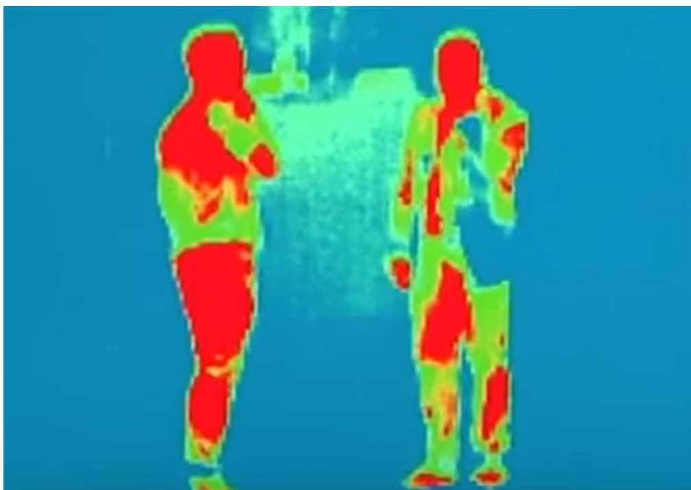
Figur 4. Bilden som operatören ser vid användande av infrarödsläget på FUMOs kamera (Fumo, 2016).
